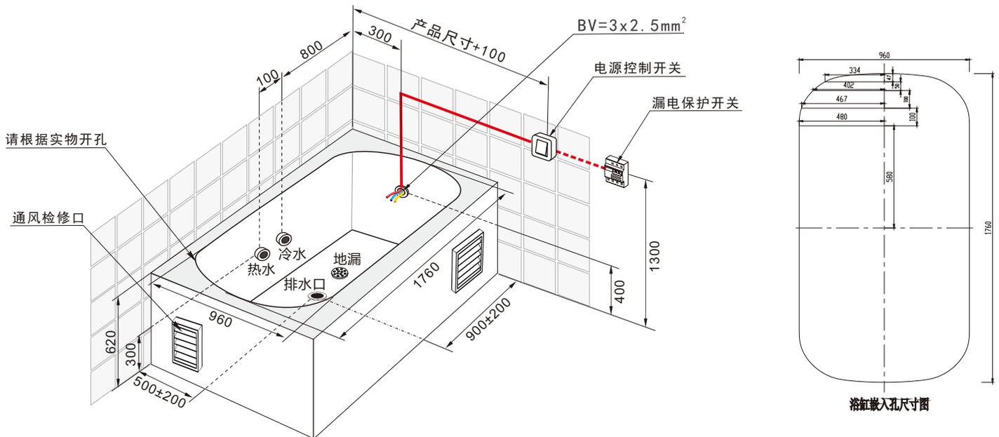
注意：电源线与产品接线盒连接后，接线盒不能放置在地面上，务必固定在浴缸支架上。
